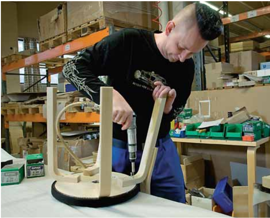
Aallon pikkutuolin kokoamista HKT Korhosen tehtaalla.
