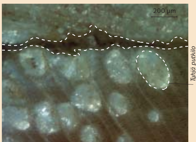
Kuva 4. Kuvassa on poikkileikkaus parketista, jonka kulutuspinna on saarnea. UF-liimasauma näkyy tummanruskeana vaakasuuntaisena raitana.
