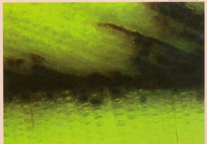
Kuva 5. Fenoli-liimalla liimattua kuusta. Kuvauksessa on käytetty fluorisoivaa valoa. Sauman alapuolella liiman tunkeutuminen puuhun on vähäistä poikittaisen syyn ja kesäpuun takia, yläpuolella sen sijaan erinomaista, ilmeisesti kevätpuun takia ja koska vuosikasvainten suunta lähenee sauman suuntaa.
