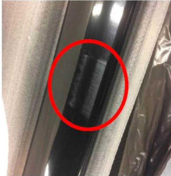
Tavallisten jauhemaalien pintakerroksen tyypillinen vaurio
